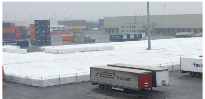
Beispiel einer Plattformlagerung von Pellets mit Hauben aus Polyethylen, vor Versendung zu den einzelnen Filialen.
