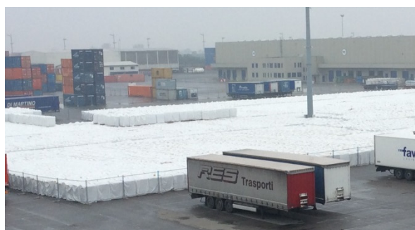
Esempio di stoccaggio massivo di Pellett in bancali protetti da cappucci in polietilene, in attesa di essere distribuito
